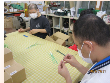
自動車部品のコネクター 決められた場所にコードの端子を差し込みます
